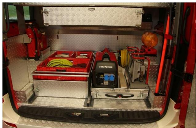
Auf Auszügen gelagert der Stromerzeuger mit Beleuchtungsmaterial. Daneben eine Box mit Tauchpumpen.
