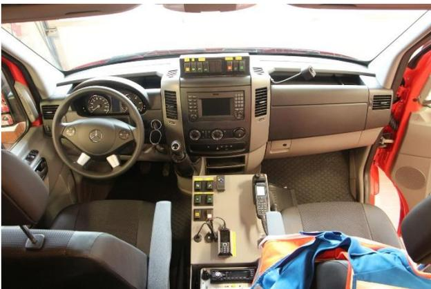
Im Fahrerbereich sind die Bedienelemente für Blaulicht, Funk, Handy und Mobela untergebracht.
